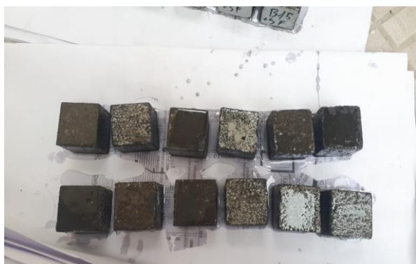
Hình 6. Mẫu BT sau khi quét sơn chống thấm.
